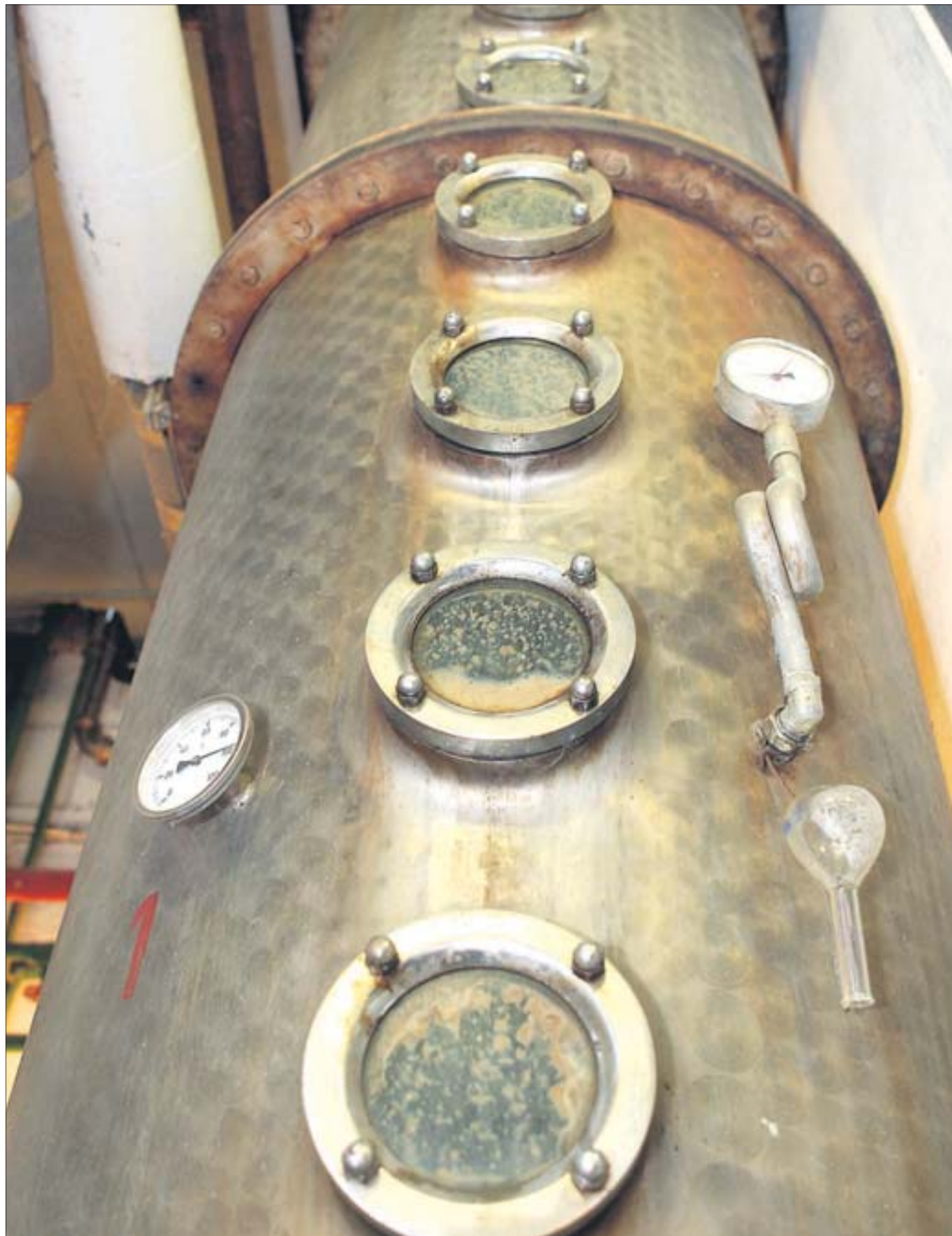
Herzstück ist die sechs Meter hohe Destillationskolonne. Auf 14 Etagen, jeweils durch ein Bullauge angezeigt, wird bei knapp 100 Grad Celsius die braune Brühe Stufe für Stufe zu klarem Korn gebrannt. Ganz oben auf der Kolonne ist der Dephlegmator. Hier kondensiert der Schnaps.
