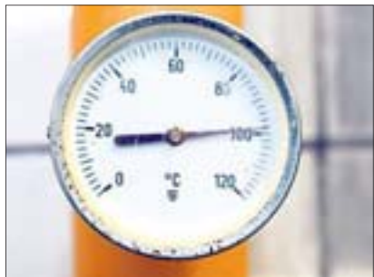
Die entscheidende Temperatur in der Kolonne (großes Bild): Bei knapp unter 100 Grad Celsius entsteht der Kornrohbrand.
