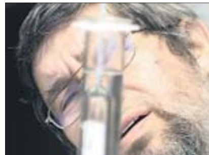
Genau schaut Hans Liebe in das Reagenzglas, um an der Lage der Spindel den Alkoholgehalt ablesen zu können.
